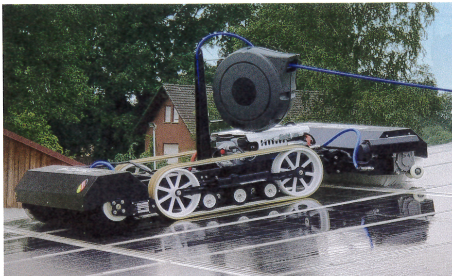
Der Reinigungsroboter wird auch auf Dächern eingesetzt. Die Sicherung erfolgt über eine Seilrolle.
