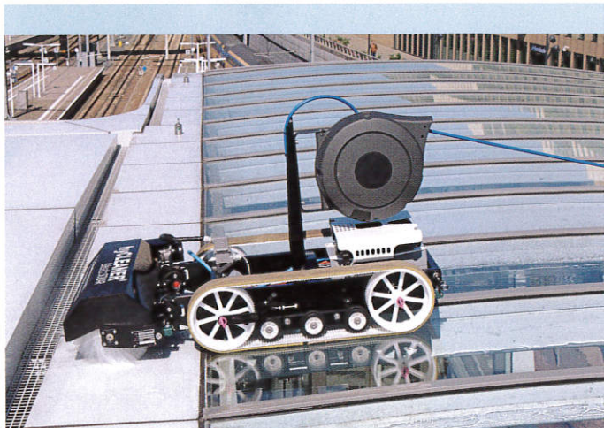
Zu reinigen waren Stahl-, Aluminium- und Glasflächen. Je nach Verschmutzungsgrad stehen zwei Fahrgeschwindigkeiten zur Verfügung.
