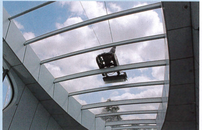
Bei der Reinigung der Bahnsteigüberdachung. Die Maschine wird per Funkfernsteuerung bedient.
