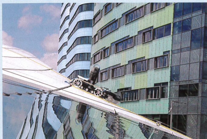
Das Befahren und Reinigen auf Neigungen von bis zu 35 Prozent sind ohne zusätzliche Absicherung möglich.
